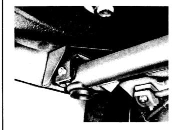
En procédant côté par côté pour éviter le basculement de la traverse, desserrer les écrous, déposer les arrêtoirs et laisser descendre la traverse de 10 mm environ.
