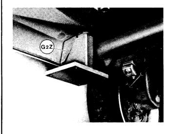
Placer le support (G2Z), le maintenir en place par un léger serrage des écrous.
